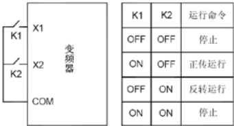
图5-3-1 两线式控制（使能与方向合一）
