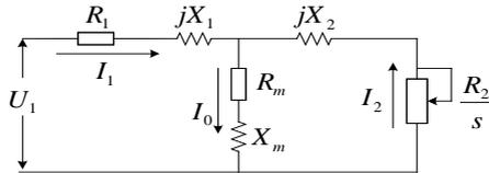
图 5-10-1 异步电机稳态等效电路图
