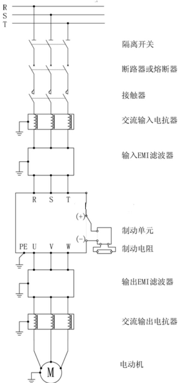
图 7-2 3030G/3030P 及以上外围设备连接图
