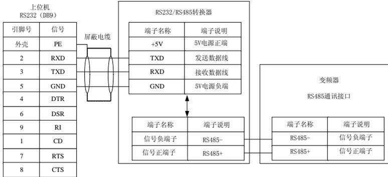
图 2-9 上位机与变频器接口接线图
