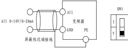
图 2-7 模拟输入端子配线图
