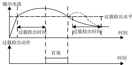
图 5-13-2 过载报警检出功能示意图
