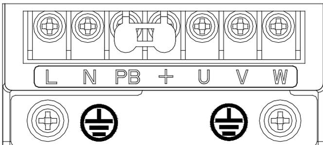
图 2-2 1PH 220V 0.4&0.75kW 主回路端子接线
