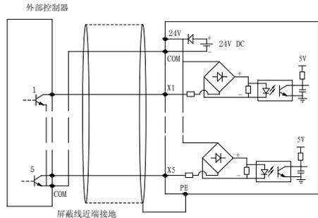
图2-11输入多功能端子配线连接图
