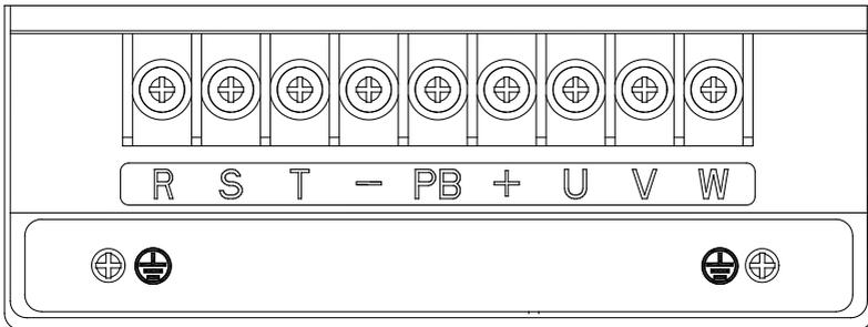
图 2-4 3PH 380V 4-30kW 主回路端子接线
