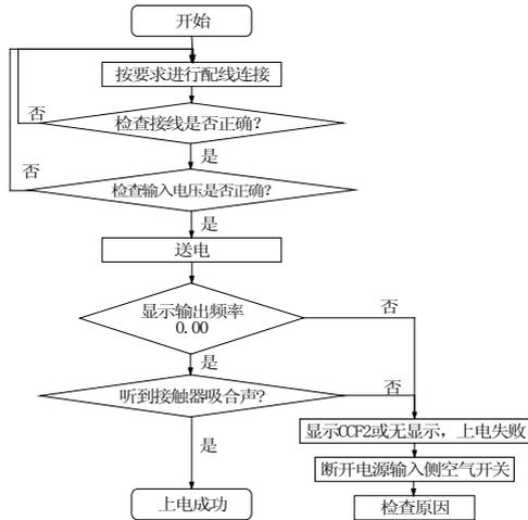
图 3-6 变频器初次上电操作流程
