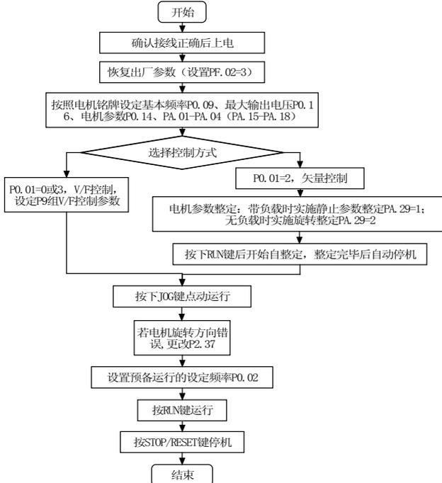
图 3-7 变频器首次试运行操作流程
