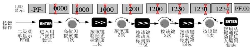
图 5-15-2 用户密码解锁流程
