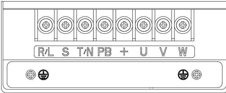
图 2-3 1PH 220V 1.5&amp;2.2kW、3PH 380V 0.75-2.2kW 主回路端子接线
