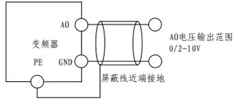
图 2-8 模拟输出端子配线图
