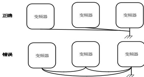
图 2-5 接地线连接方法
