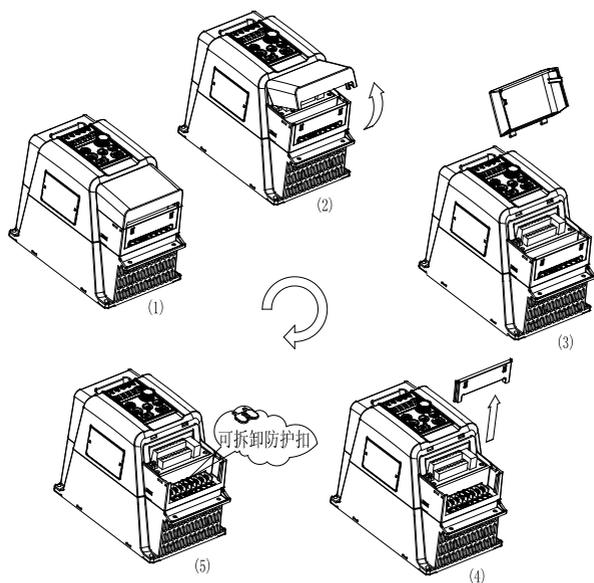
图 2-6 4kW 及 4kW 以下机型拆装示意图
