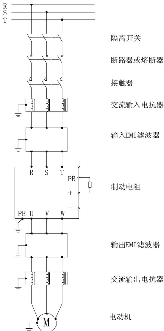
图 7-1 S2R4GB-3022GB/3022PB 外围设备连接图
