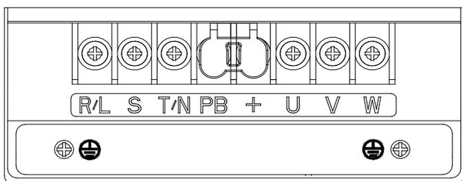
图2-10 1PH 220V 1.5&2.2kW、3PH 380V 0.75-2.2kW主回路端子接线
