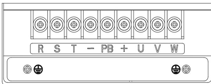
图 2-11 3PH 380V 4-30kW 主回路端子接线
