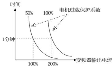
图 5-13-1 电机过载保护系数设定
