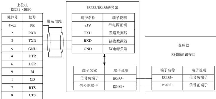
图 2-19 上位机与变频器接口接线图
