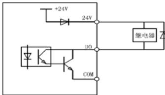
图 2-22 多功能输出端子开关量输出接线方式1
