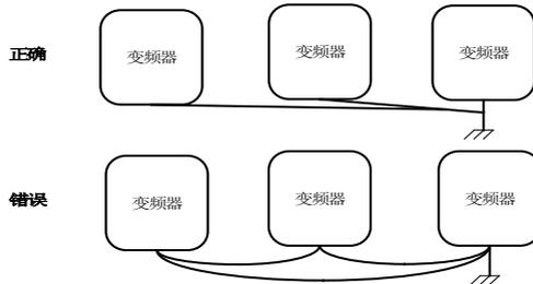
图 2-13 接地线连接方法
