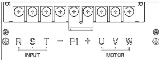
图 2-12 3PH 380V 37kW 及以上主回路端子接线
