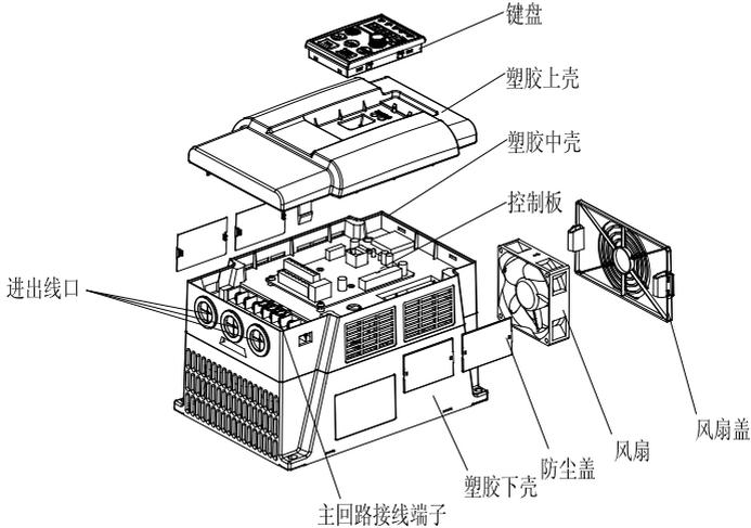
图 2-4 5.5kW-22kW 机型组件图
