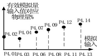
图 5-4-2 模拟输入非线性曲线
