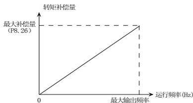
图 5-8-2 高速转矩补偿量与输出频率关系图
