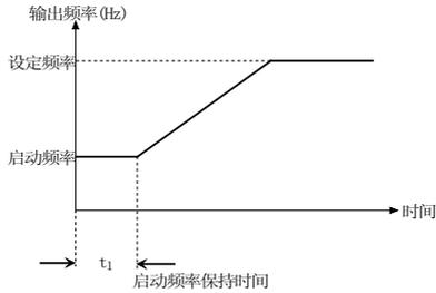
图 5-1-3 启动频率与启动时间示意图
