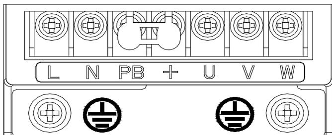
图 2-9 1PH 220V 0.4&0.75kW 主回路端子接线
