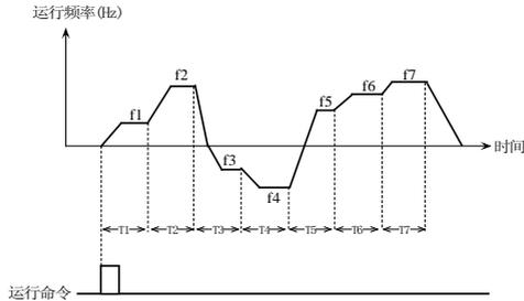
图 5-5-1 PLC 单循环后停机方式
