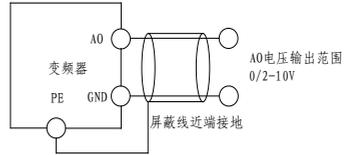
图 2-18 模拟输出端子配线图
