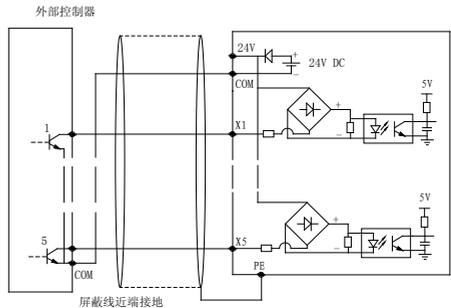
图2-21输入多功能端子配线连接图
