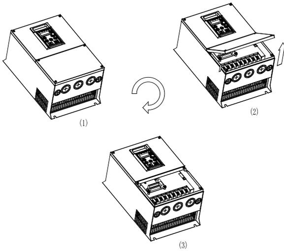
图 2-8 30kW 及以上机型拆装示意图
