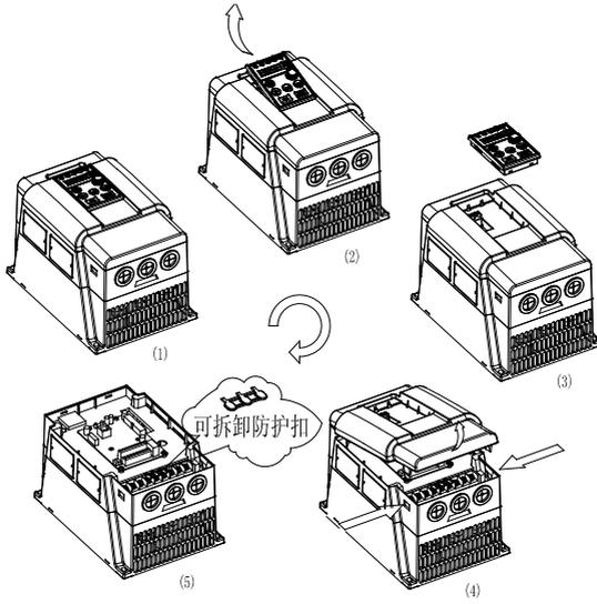
图 2-7 5.5kW-22kW 机型拆装示意图
