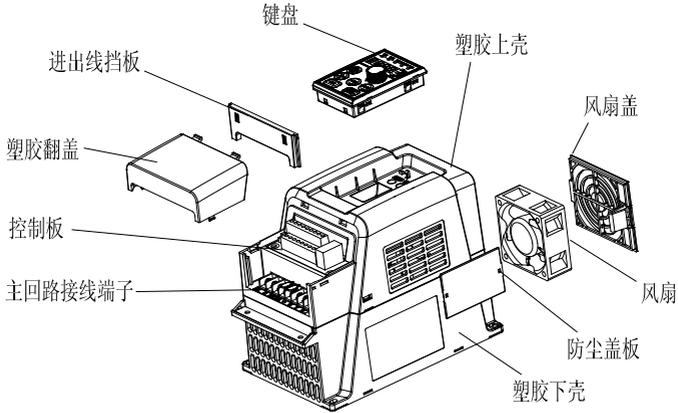
图 2-3 4kW 及 4kW 以下机型组件图
