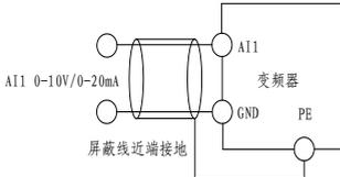
图 2-17 模拟输入端子配线图
