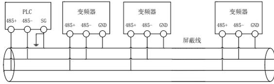
图 2-20 PLC与变频器多机通讯时推荐的接线图（变频器、电机全部良好接地）
