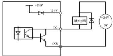
图 2-23 多功能输出端子开关量输出接线方式2
