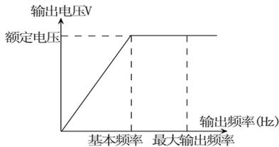
图 5-0-1 输出频率与输出电压关系图
