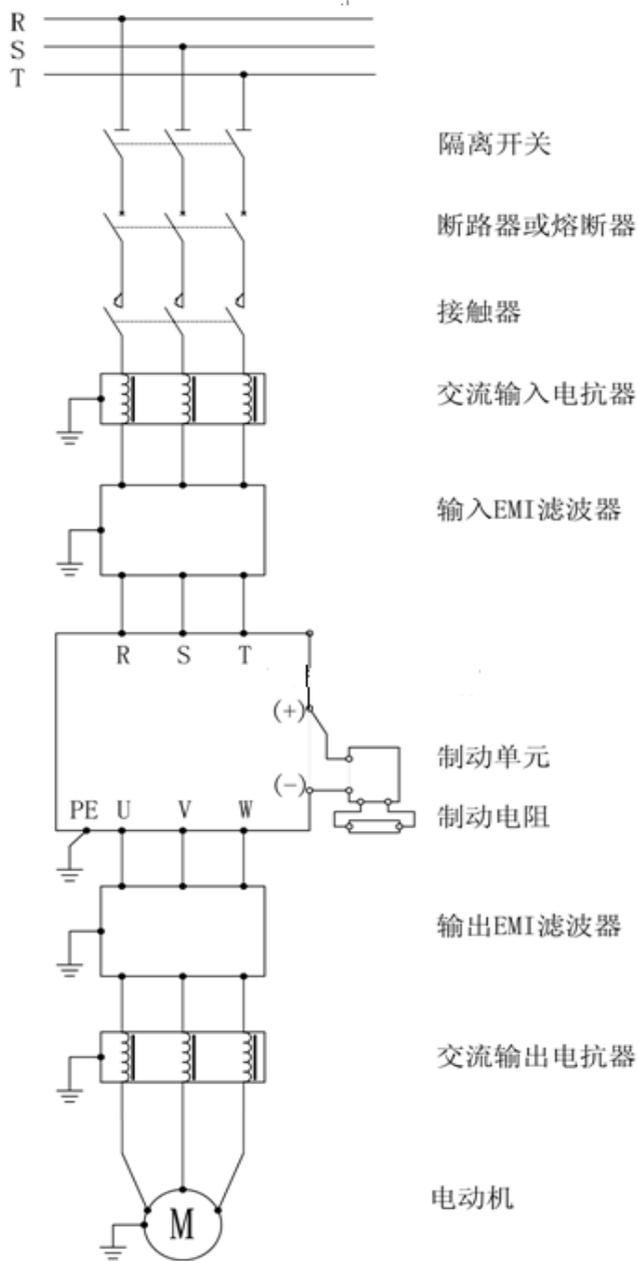
图 7-2 3030G/3030P 及以上外围设备连接图
