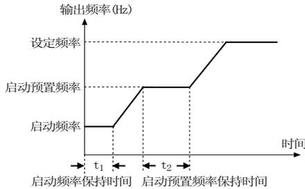
图 5-1-4 启动频率与启动预置频率示意图
