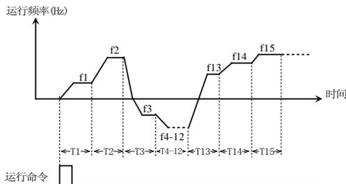
图 5-5-2 PLC 单循环后保持方式
